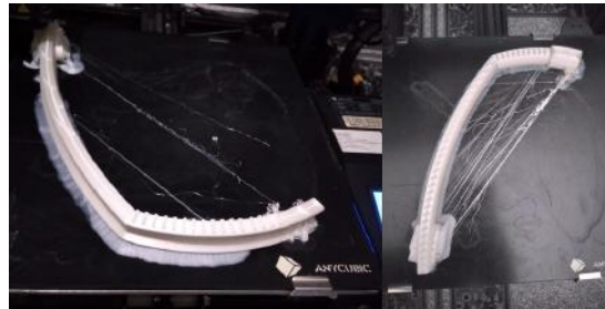
Imagem 75: Peças impressas da junção
