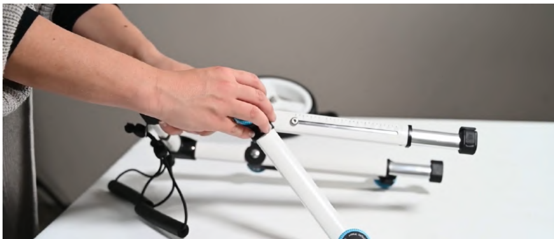
Imagem 36: Ajuste de altura da cadeira e fixação das hastes
