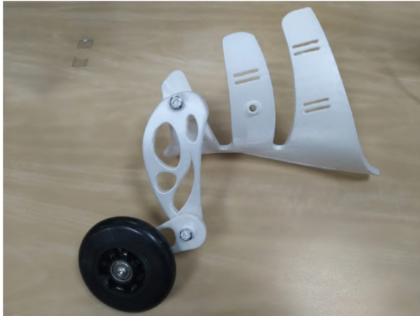
Imagem 70: Lado esquerdo montado ainda sem as pegas para formar os manípulos
