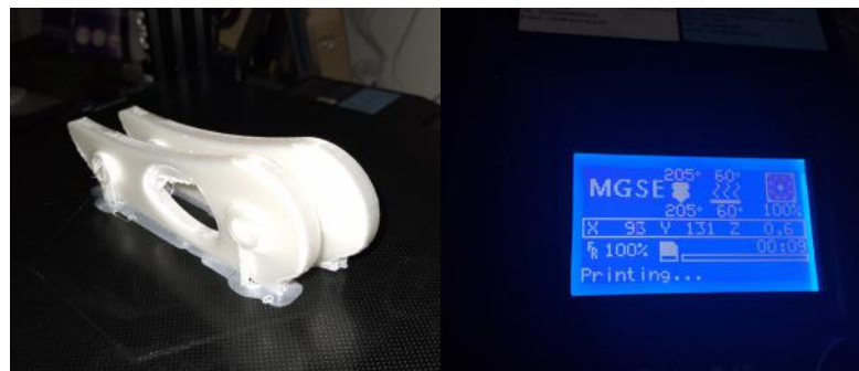
Imagem 65: Impressão das peças inferiores das pernas
