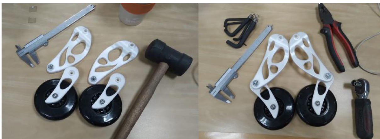
Imagem 67: Peças da perna já acabadas, com porcas inseridas e fixadas entre si
