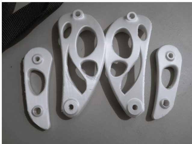
Imagem 66: Resultado de impressão das peças inferiores e superiores das pernas (ainda sem acabamento)
