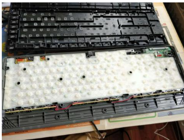
Figura 52 – Teclado desmontado, revelando uma membrana de domos de borracha
