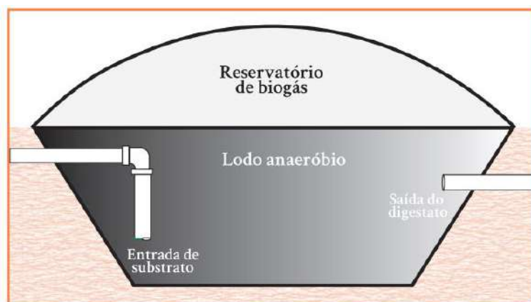
Figura 21 - Biodigestor tipo Lagoa Coberta.
