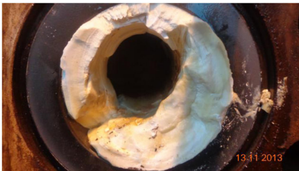
Figura 23: Exemplo de incrustação no interior de tubulações de petróleo, retirado de Marais. [79]
