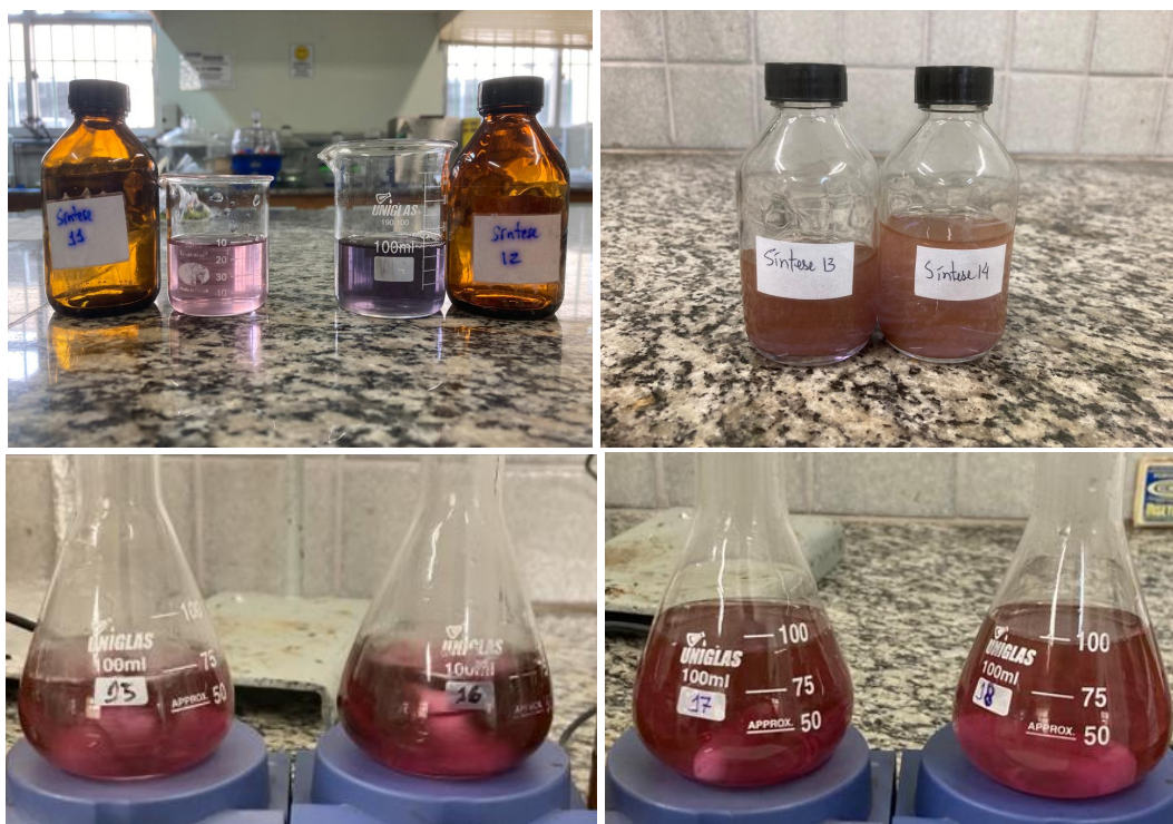
Figura 29: Variação da cor final das sínteses em função da proporção inicial entre ouro e ranelato.
