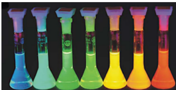
Figura 12: Nanopartículas de CdSe-CdS núcleo casca, de tamanhos entre 1,7 nm e 6 nm, retirado de Asha. [22]
