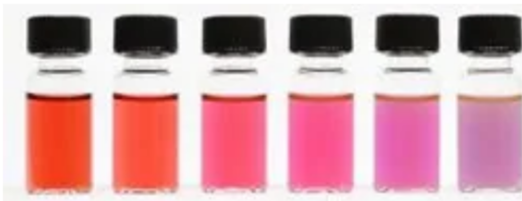
Figura 16: Variação da cor de nanopartículas de ouro dispersas em solução de água, retirado de SigmaAldrich. [54]
