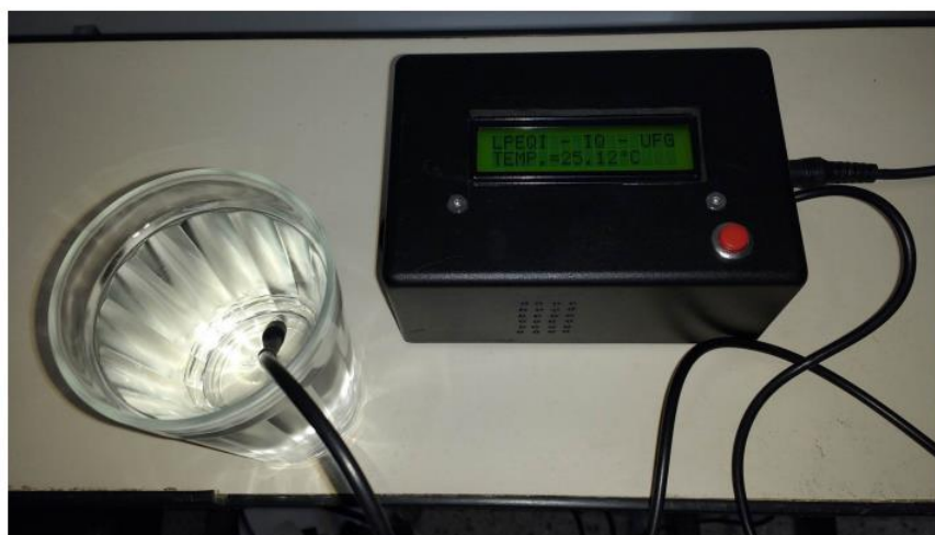
Figura 17: Termômetro vocalizado. Fonte: (Benite et al. 2017)
