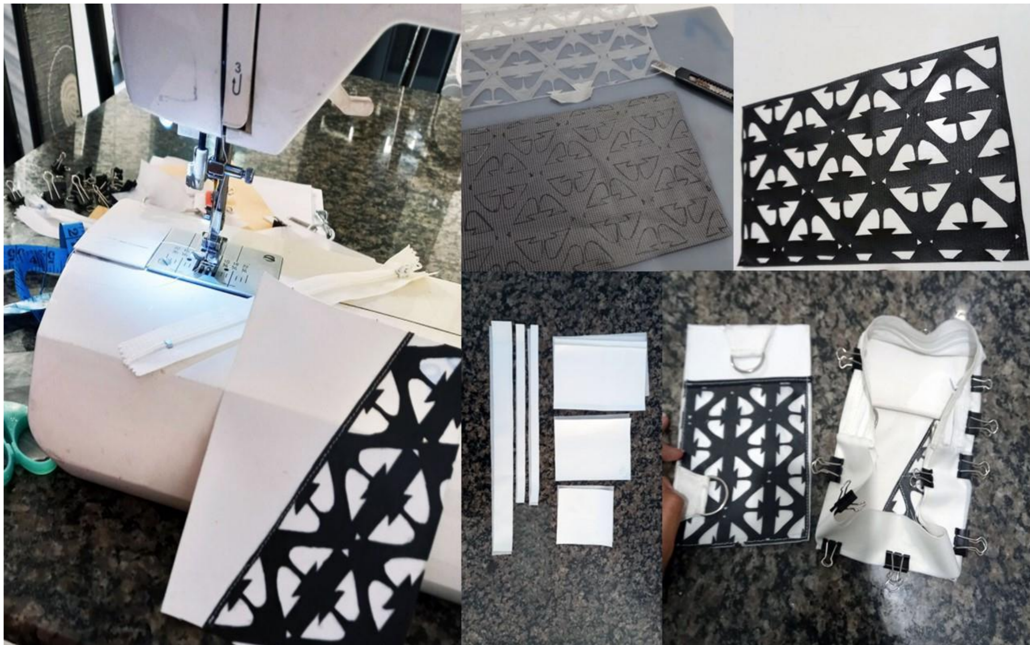
Figura 42 – Processo de costura da bolsa pequena e detalhes em corino
