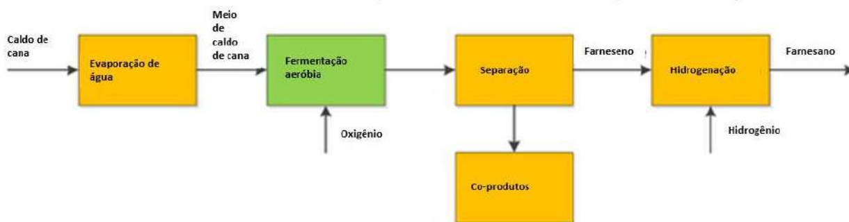
Figura 3 – Diagrama de blocos da conversão direta de açúcares em hidrocarbonetos
