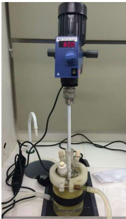
Figura 11 - Unidade experimental empregada na produção de nanopartículas poliméricas de ácido acrílico, por meio de polimerização em miniemulsão inversa. (Fonte: elaboração própria.)
