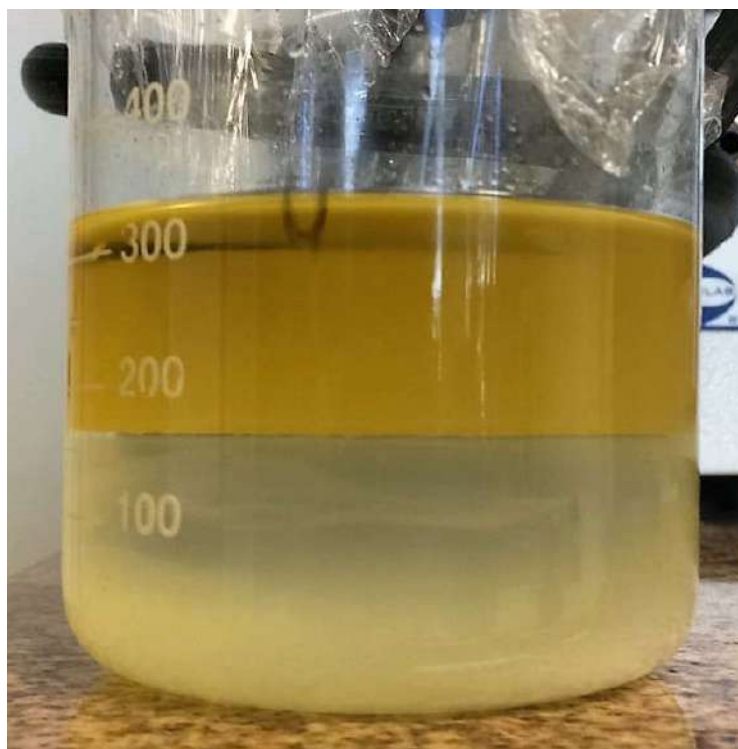
Figura 13 – Início da etapa de purificação das partículas de PAA obtidas por reação de polimerização em miniemulsão inversa. (Fonte: elaboração própria.)
