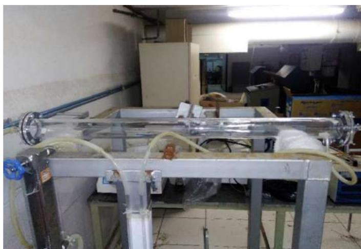
Figura 3.1 – Permeômetro de acrílico.
