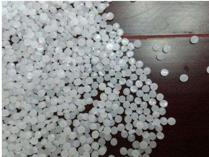
Figura 3.5 – Amostras do PEAD BF4810/Brasken utilizado como meio para o ensaio de permeamtria.
