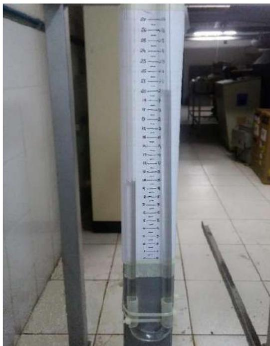
Figura 3.4 – Tubo em U para medição da queda de pressão.
