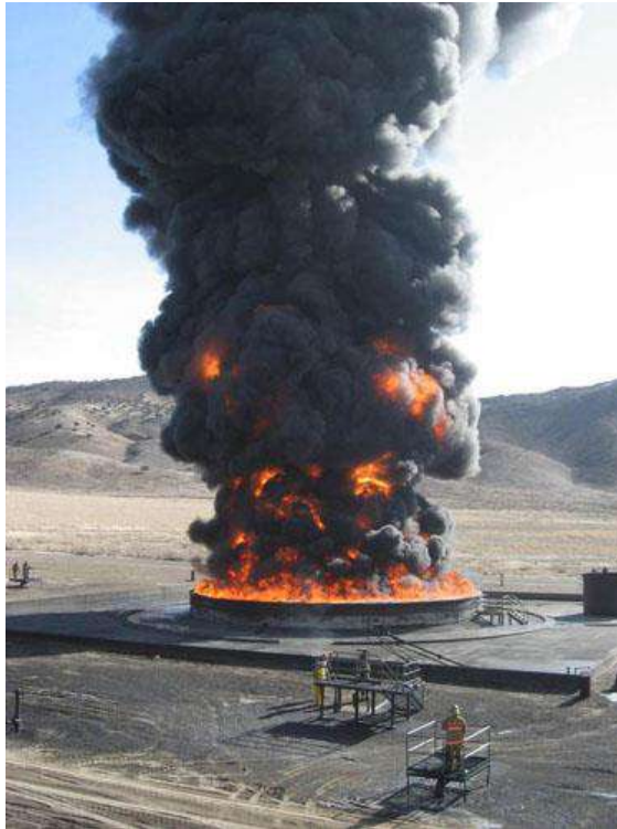
Figura 27 - Redução de luminosidade da chama devido à fumaça Fonte: VAZ (2017)
