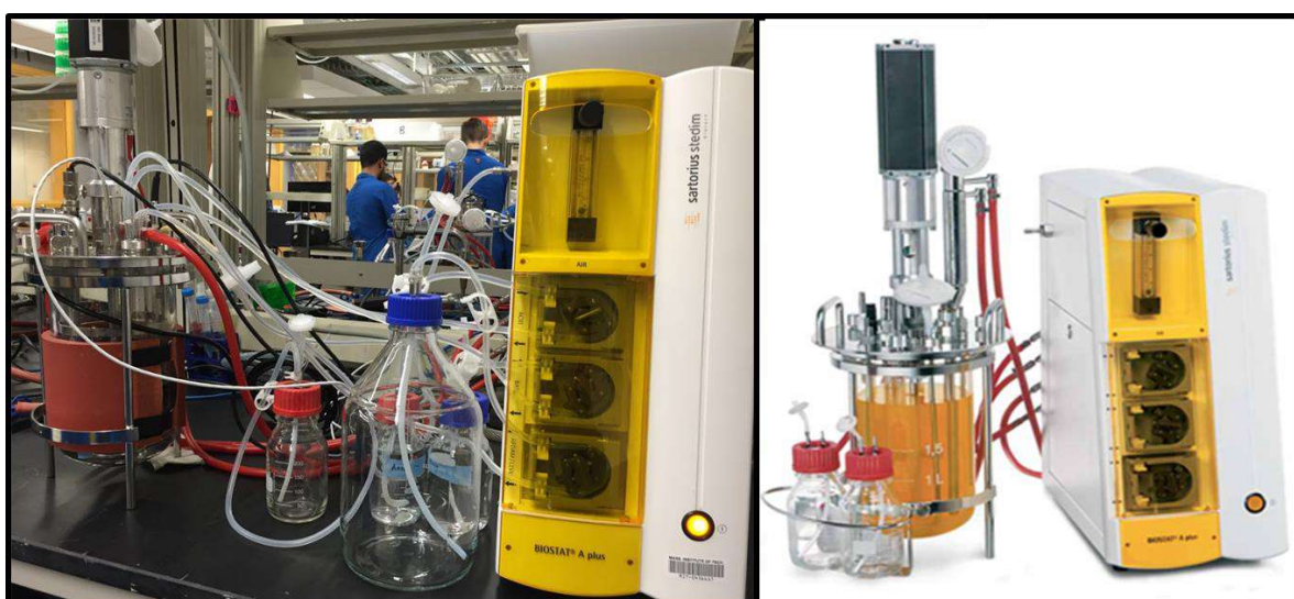
Figura 16. Biorreator Sartorius Biostat A Plus utilizado no estudo
