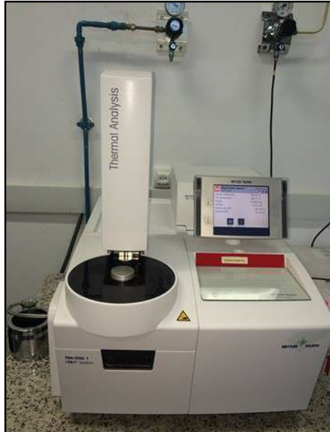
Figura 40 - Equipamento TG/DSC conectado à solução de permanganato de potássio. Fonte: Autora
