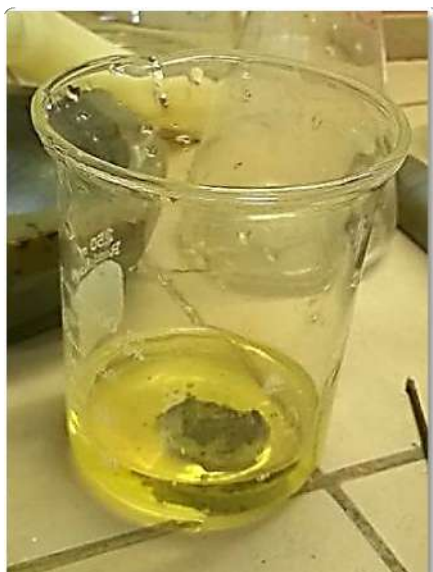
Figura 34 - Dissolução do amálgama de prata com ácido nítrico. Fonte: Autora
