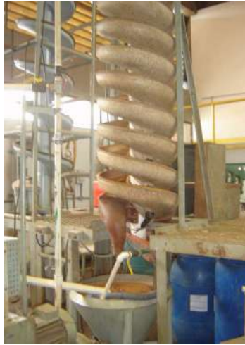
Figura 19 – Espiral de Humphrey. Fonte: Braga. P.F.A., 2014
