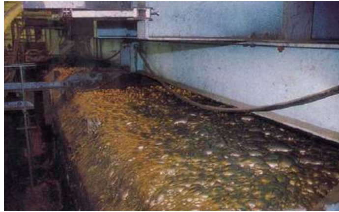
Figura 15 - Processo de flotação do ouro. Fonte: miningeducation.com, 2012
