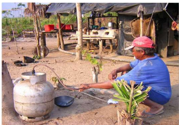
Figura 8 - Decomposição térmica do amálgama a céu aberto. Fonte: Castilhos. Z. C., 2014
