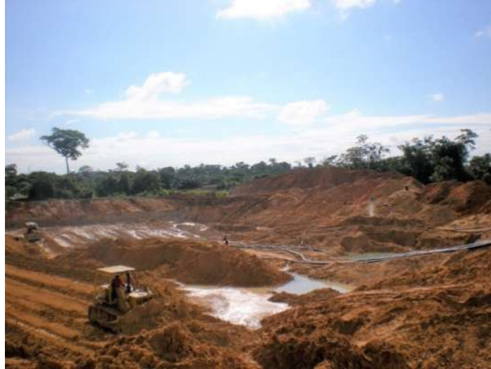
Figura 11 - Desmonte de minério secundário com a utilização de monitor hidráulico no norte de Mato Grosso. Fonte: Araújo, P.C., 2017
