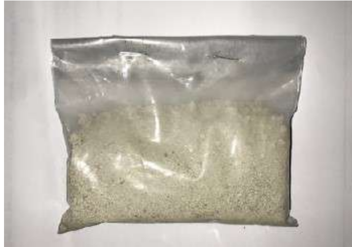
Figura 31 - Prata metálica produzida. Fonte: Autora
