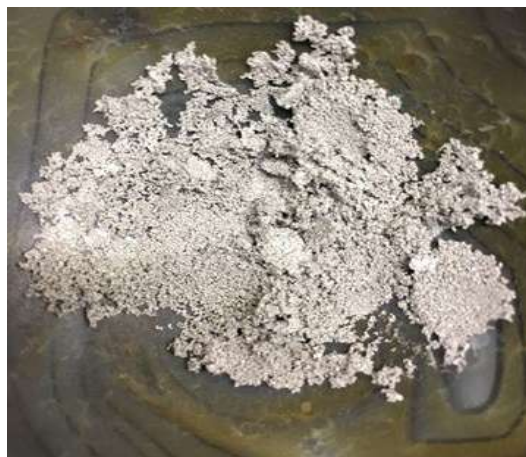
Figura 32 - Amálgama com proporção 1Ag:4Hg. Fonte: Autora
