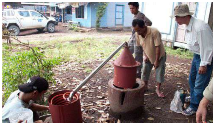
Figura 29 - A comunidade de mineração de ouro de Kalimantan, Indonésia usando uma retorta artesanal. Fonte: Yayasan Tambuhak Sinta apud worstpolluted.org, 2009
