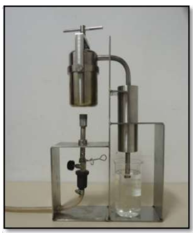
Figura 7 - Retorta desenvolvida pelo CETEM - RETORCET Fonte: Braga, P.F.A.; Araujo, R.V.V.,2007
