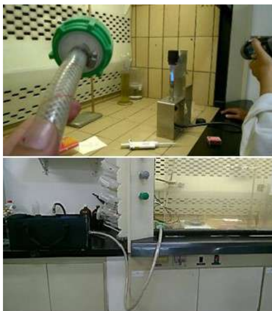
Figura 39 - Posicionamento do LUMEX durante a decomposição térmica do amálgama de prata a 400^\circ\text{C} . Fonte: Autora
