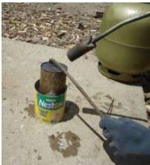
Figura 30 - Retorta artesanal desenvolvida por Marcelino Junior; Garimpeiro; UFBR. Fonte: Acervo de Patrícia Araújo - CETEM/RJ
