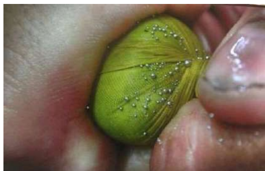
Figura 6 - Squeezing do amálgama. Fonte: Acervo Luis G.S.Sobral – CETEM RJ
