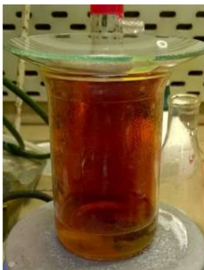
Figura 35 - Desprendimento de gás nitroso durante a digestão do amálgama. Fonte: Autora
