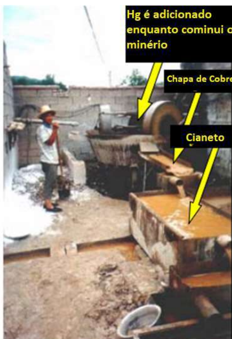
Figura 9 - Cianetação de rejeitos de amalgamação. Fonte: AJ Gunson (China,2002) apud Veiga, M.M., 2005
