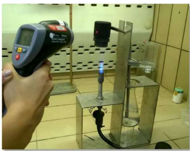
Figura 33 - Temperatura de decomposição térmica medida com termômetro infravermelho. Fonte: Autora
