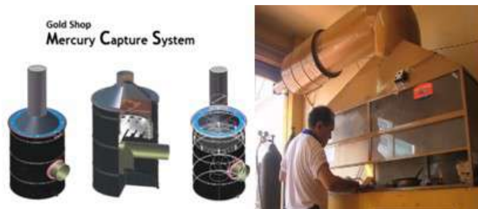
Figura 26 - Sistema de captação de mercúrio. Fonte: EPA,2013
