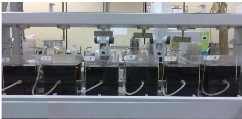
Figura 11. Aparelho de “Jar-Test” utilizado no processo de coagulação/floculação.
