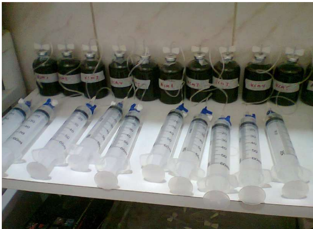
Figura 3.1 - Frascos de penicilina dos ensaios de biodegradabilidade anaeróbia
