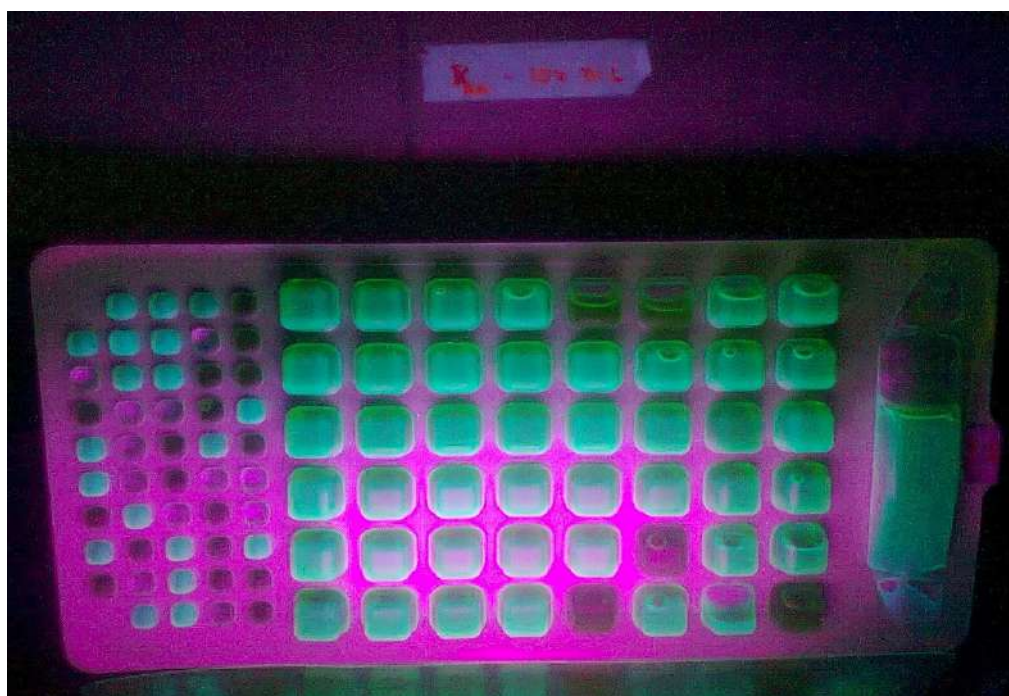
Figura 3.3 – determinação de coliformes termotolerantes em amostra de efluente
