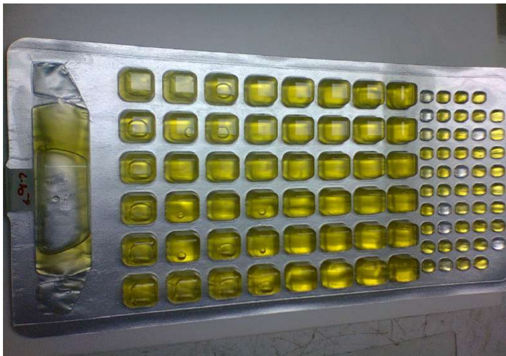
Figura 3.2 – determinação de coliformes totais em amostra de efluente
