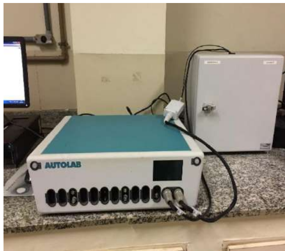
Figura 26 - Potenciostato-Galvanostato AUTOLAB PG 302N, utilizado na realização dos experimentos de espectroscopia de impedância eletroquímica. Fonte: Arquivo pessoal
