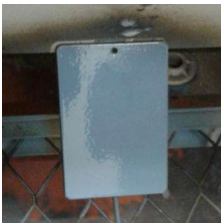
Figura 32 - Superfície após aspersão do CP com Poliamida 12 sem Nióbio. Fonte: Arquivo Pessoal
