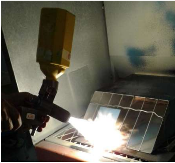
Figura 20 - Processo de Aspersão Térmica. Fonte: Arquivo pessoal
