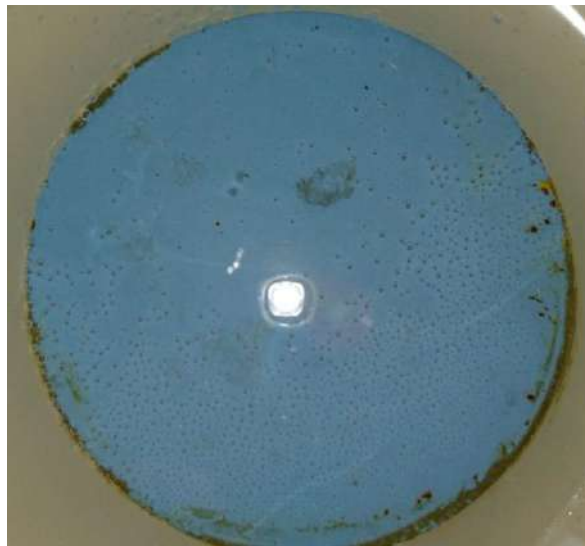
Figura 39 - Aspecto do corpo de prova PA12 ao fim do experimento
