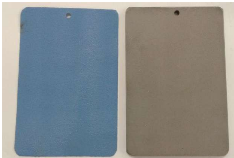
Figura 22 - Filme de PA12 descolado à esquerda, placa de aço carbono à direita. Fonte: Arquivo pessoal
