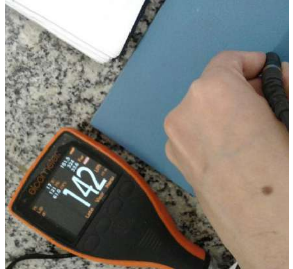
Figura 21 - Procedimento de medição de espessura. Fonte: Arquivo pessoal
