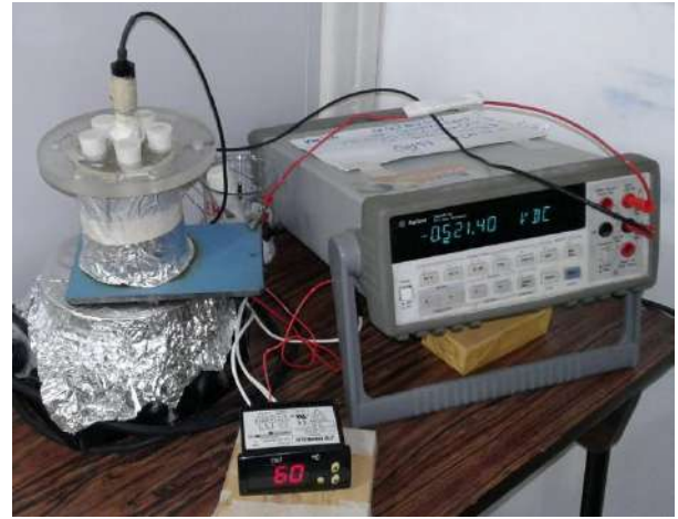
Figura 25 - Ensaio de OCP para aço carbono revestido a 60°C. Fonte: Arquivo pessoal
