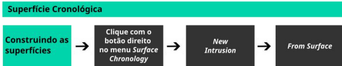
Figura 22. Fluxograma para a construção de superfícies usando meshes
