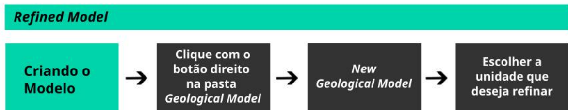
Figura 20. Fluxograma detalhado para a construção do modelo refinado.
