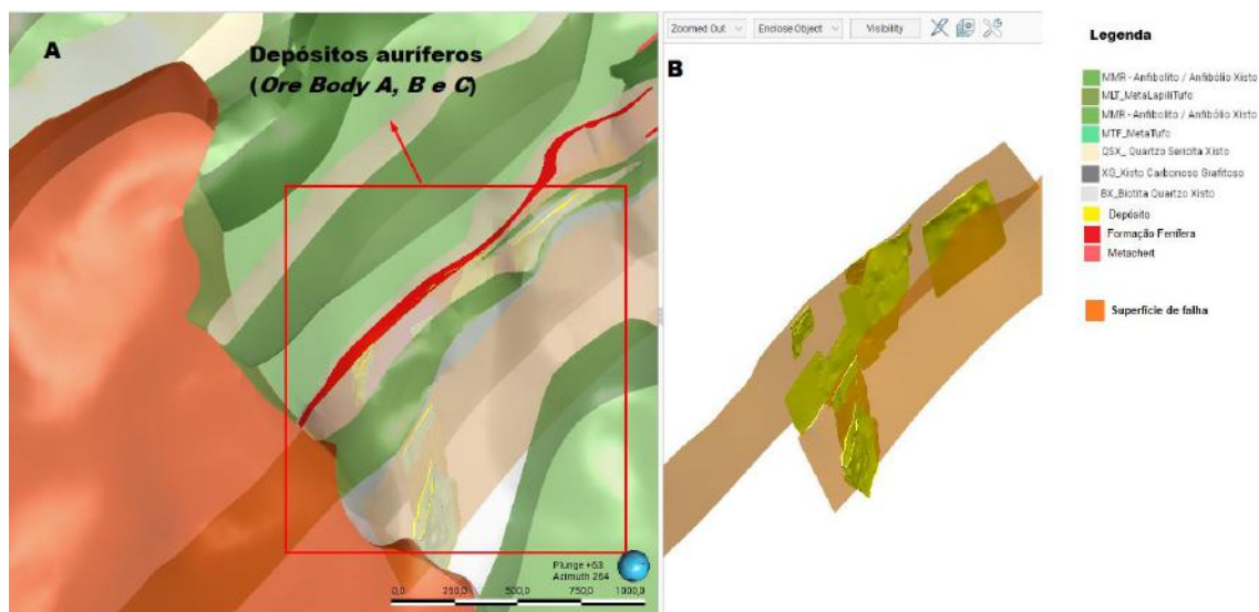
Figura 43. A) Depósitos auríferos do Complexo Turmalina. B) Corpos mineralizados seguindo a tendência das falhas do Lineamento Pitangui
