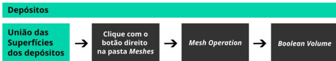
Figura 33. Fluxograma da construção de uma Mesh agrupando diversas outras
