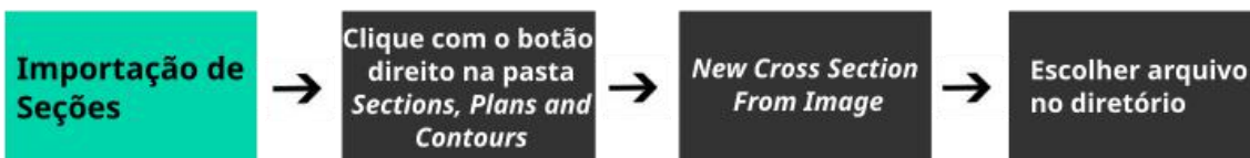
Figura 26. Fluxograma referente a criação de seção geológica a partir de uma imagem
