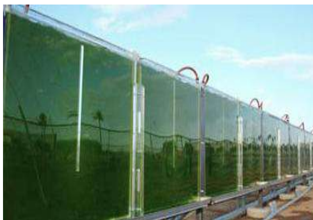
Figura 2.6 – Fotobiorreator de placa plana desenvolvido na Arizona State University (EUA)
