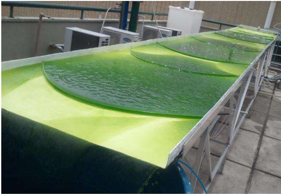
Figura 2.2 – Sistema inclinado de cultivo de microalgas instalado no laboratório GreenTec/EQ/UFRJ (Aranda et al, 2016).
