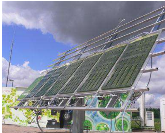
Figura 4.2 – Fotobiorreatores de placa plana direcionáveis (Hindersin et al, 2013)
