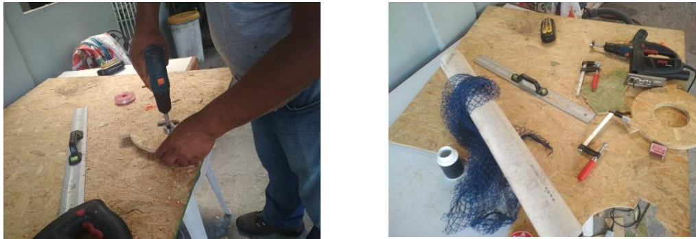
Figura 55 – Construção do protótipo da ferramenta de inserção de algas na rede tubular.
