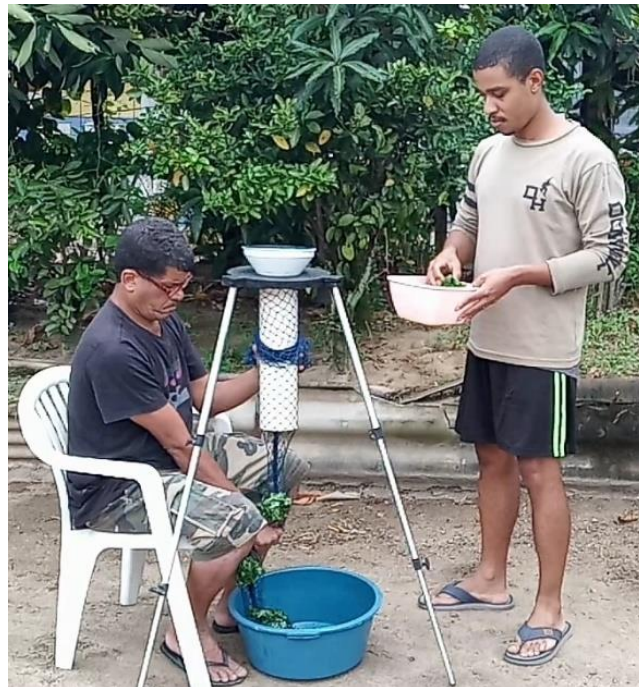
Figura 57 – Protótipo da ferramenta de inserção de algas na rede tubular - fase de testes.
