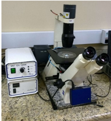
Figura 3.2. Microscópio Axiovert 40 MAT da Carl Zeiss.
