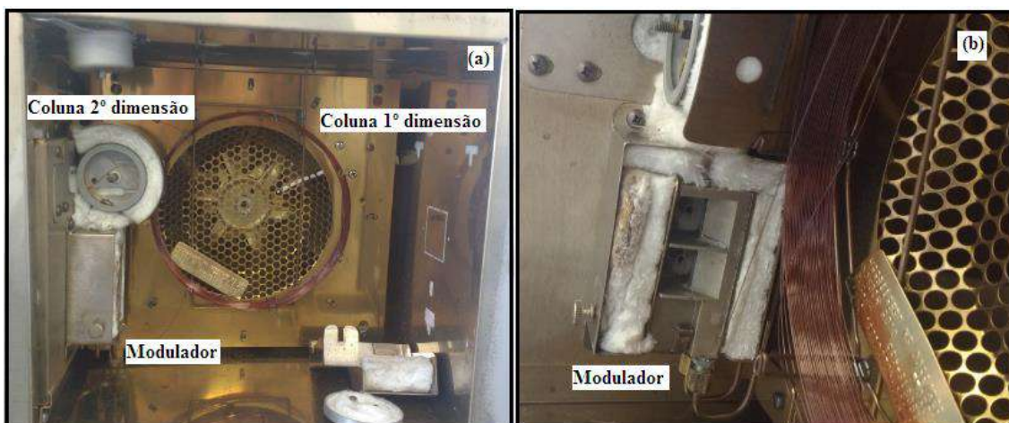
Figura 12: Forno do cromatógrafo aberto mostrando (a) a posição do modulador e as colunas de primeira e segunda dimensão e (b) o modulador em detalhes.
