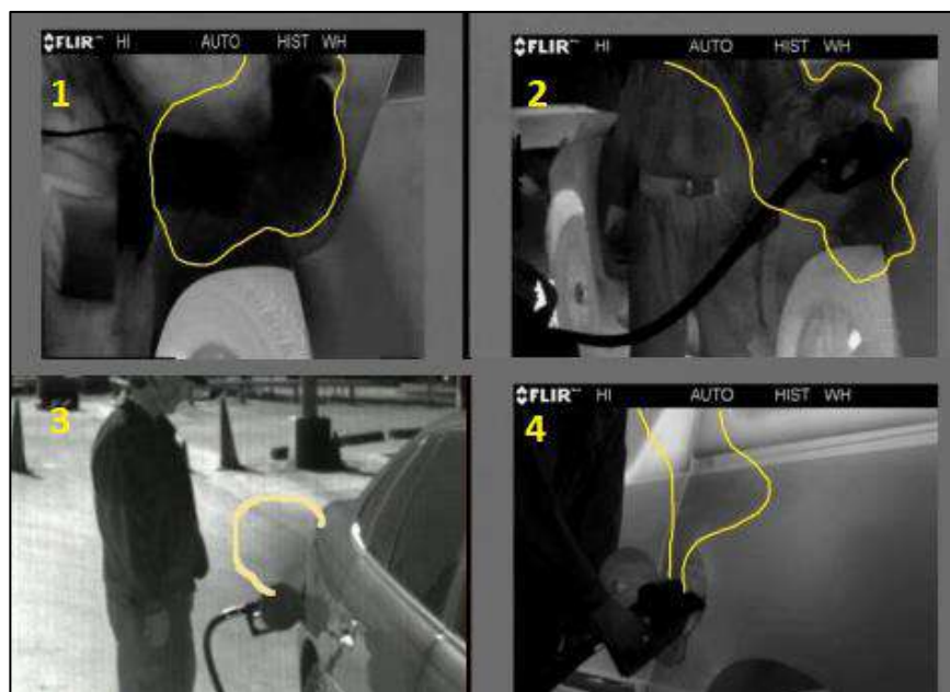
Figura 2.1 – Imagens de vapor de gasolina obtidos através de câmera térmica. Fonte: ALYAMI, 2016.
