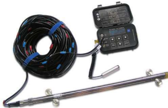
Figura 1.2: Torpedo eletrônico e a unidade de leitura 3Geo Tecnologia.
