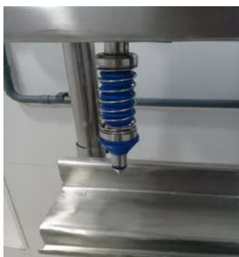
Figura 24- Vista frontal de um dos bicos injetores da máquina envasadora
