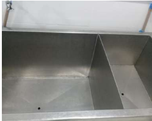
Figura 11- Vista de cima do tanque de imersão de alimentos, evidenciando a barreira física entre os lados esquerdo e direito onde são feitas as limpezas dos alimentos com ozônio e cloro respectivamente
