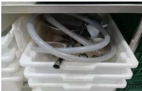
Figura 21- Mangueiras que farão a conexão entre a saída de extrato da máquina de prensagem, a bomba e a máquina envasadora
