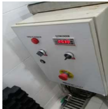
Figura 12- Painel de controle lateral ao tanque de imersão onde a concentração de ozônio é controlada
