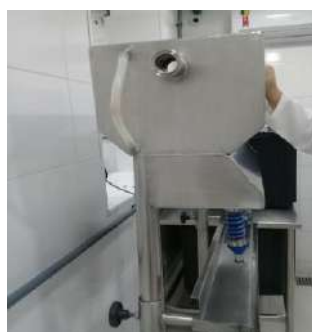
Figura 22- Conexão onde a mangueira é conectada na máquina envasadora
