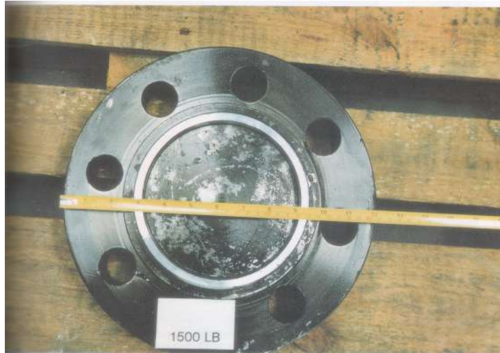
Figura II.10 - Exemplo de flange cego utilizado para vedar a tubulação que havia ficado aberta após a retirada da PSV 504 (Fonte: CULLEN, 1990 vol 2)
