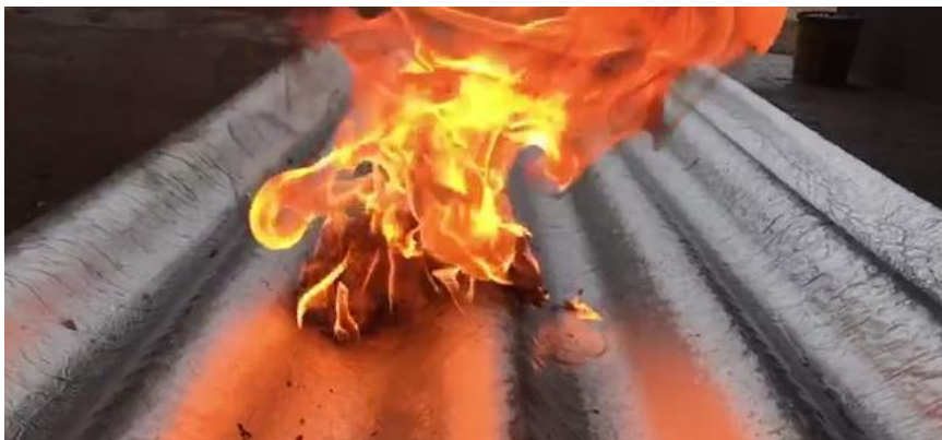
Figura 42 - Comportamento da telha ecológica na situação de incêndio. (Fonte: ecopex, 2022. https://ecopex.com.br/telha-ecologica/ )
