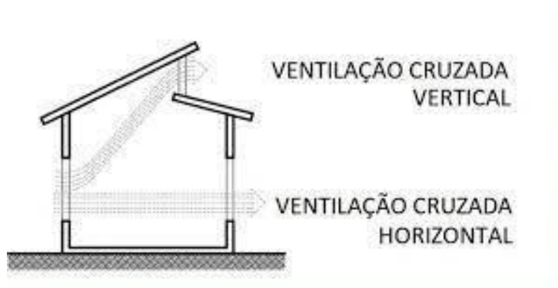
Figura 62 - Esquematização da ventilação cruzada (Fonte: Dicas de arquitetura, 2023)
