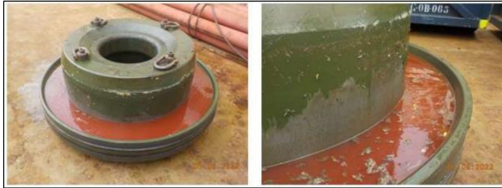
Figura 30 - Pistão do anular com desprendimento de xylan
