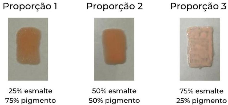
**Figura 16.** Proporções esmalte: pigmento testadas quanto a sua clareza em lâmina de vidro.
