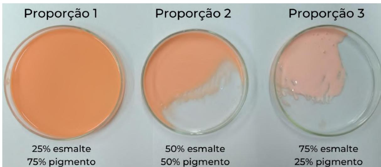
**Figura 15.** Aplicação do pigmento ao esmalte nas diferentes proporções estabelecidas para 5 mL de esmalte
