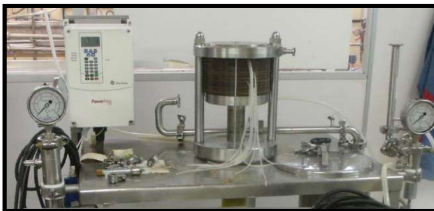
Figura 3.6: Sistema de membrana plana em módulo espiral utilizado na nanofiltração do extrato obtido, em escala piloto, a partir do bagaço de suco de uva.
