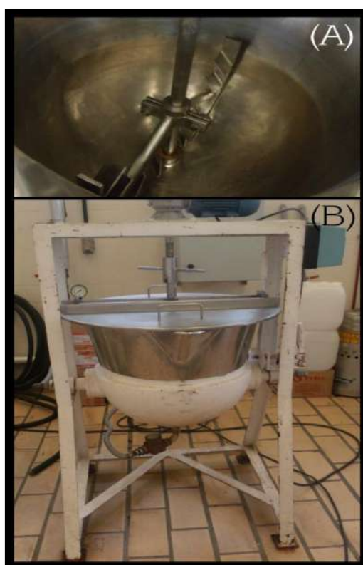
Figura 3.2: Agitador mecânico (A) do tanque encamisado (B) utilizado na extração em escala semipiloto.
