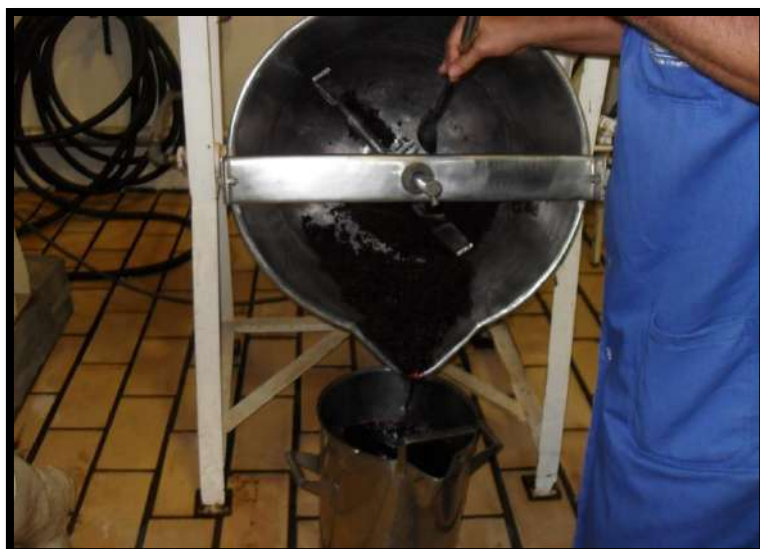
Figura 3.3: Recolhimento do extrato obtido juntamente com o bagaço residual em escala semipiloto.
