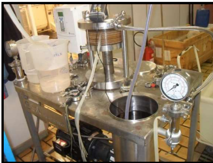
Figura 4.5: Processo de nanofiltração do extrato obtido a partir do bagaço de suco de uva, em escala semipiloto.
