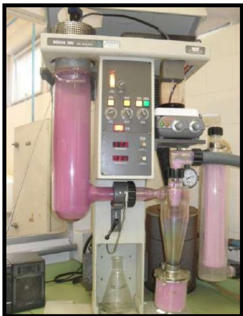
Figura 4.7: Processo de secagem por atomização do concentrado do extrato de bagaço de suco de uva.
