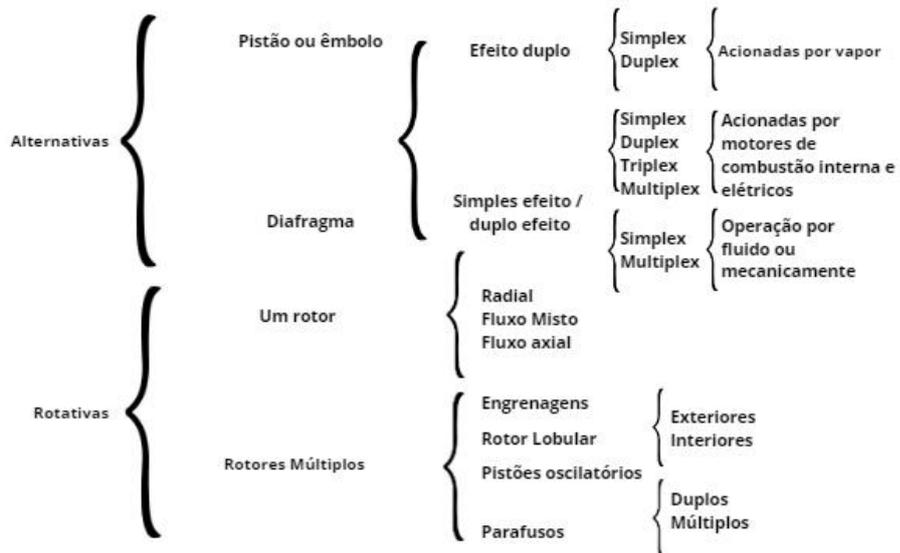
Figura 8 – Subclasses de bomba de deslocamento Positivo ("Máquina Termohidráulicas de Fluxo", 2010).
