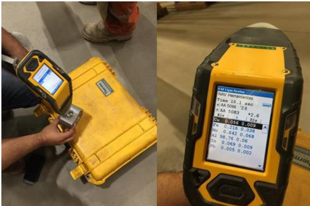
Figura 36 – Teste de composição química pelo método de *Positive Material Identification*.
