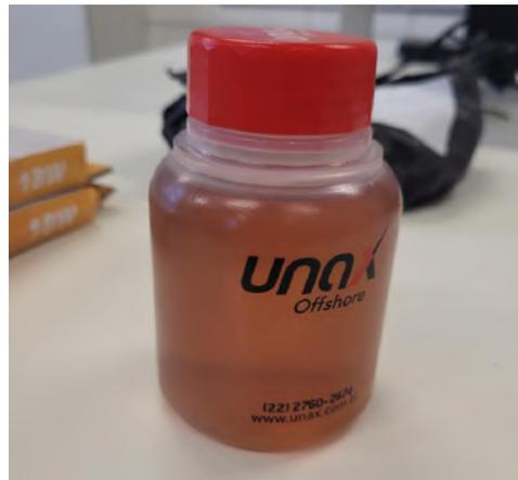
Figura 29 – Amostra de óleo hidráulico XP 46.
