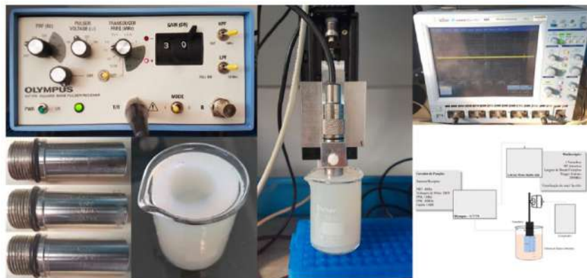
Figura 26: Equipamentos utilizados na configuração experimental para as análises de pulso-eco.
