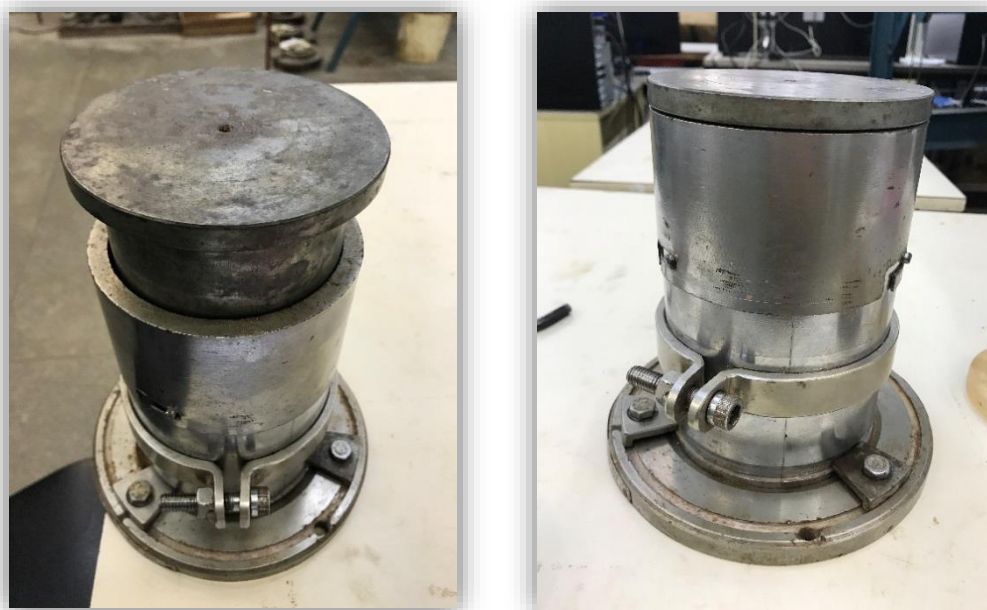
Figura 10: Antes e depois, respectivamente, da compactação estática
