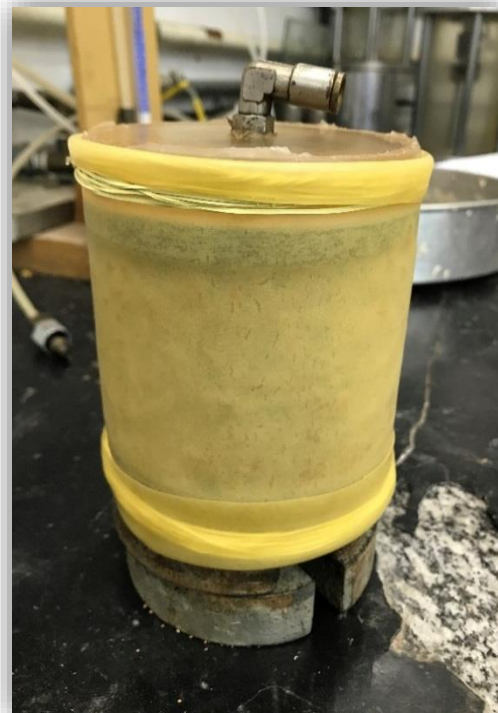
Figura 12: Corpo de prova antes e após o encamisamento (CP4 1,5% de fibras)
