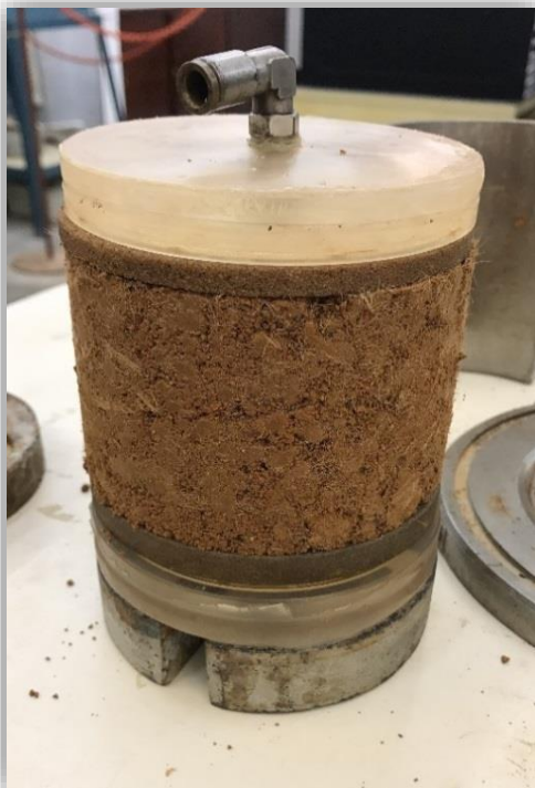
Figura 12: Corpo de prova antes e após o encamisamento (CP4 1,5% de fibras)
