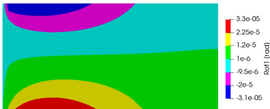
Figura 5.31: Rotação na direção  $X_1$  - Placa em balanço
