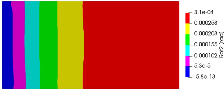
Figura 5.32: Rotação na direção  $X_2$  - Placa em balanço
