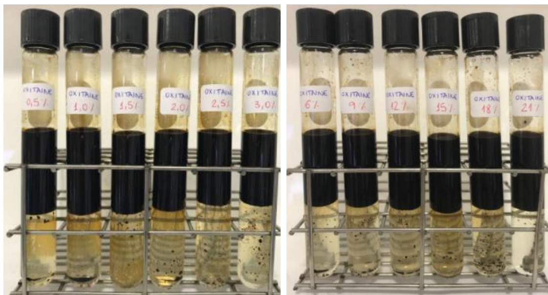
Figura 37 - Triagem de salinidade realizado para o Oxitaine CP 30 CM, com concentração de surfactante 20 vezes a CMC e volume das fases na proporção 1/1
