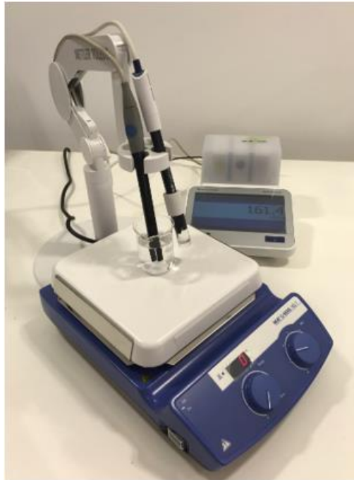
Figura 16 - Sistema montado para medição de CMC por condutimetria
