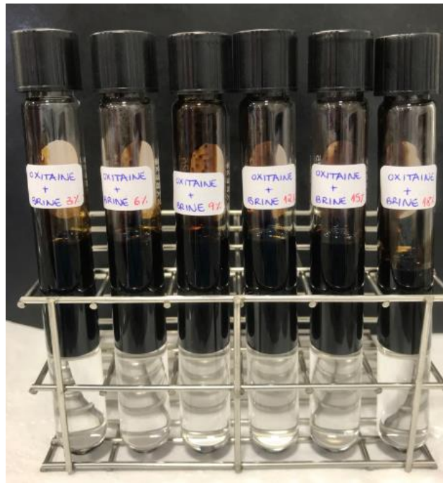
Figura 20 – Montagem do teste de triagem de salinidade
