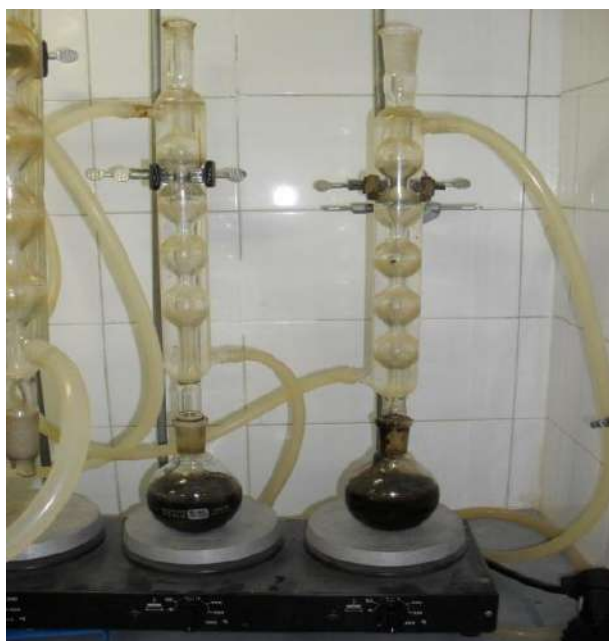
Figura III.3 Fotografia da primeira lavagem com n-heptano na extração de asfaltenos pelo Método IP 143
