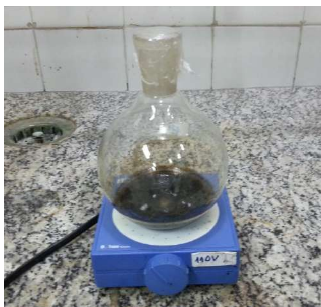
Figura III.4 Fotografia da mistura extrativa sob agitação magnética na extração de asfaltenos pelo Método Alternativo EQ/NP x
