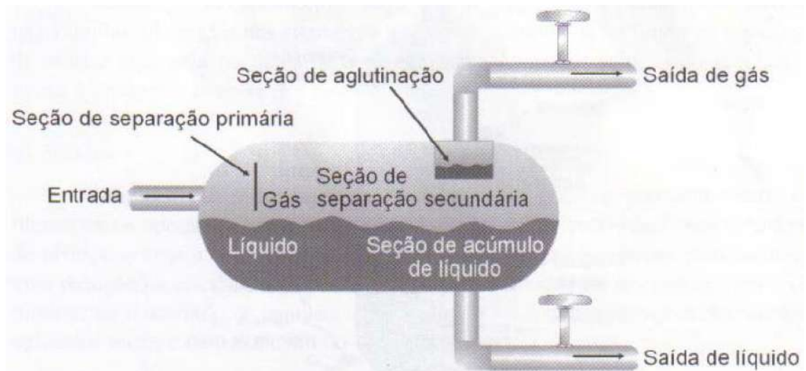
Figura 11 - Esquema ilustrativo de um separador bifásico
