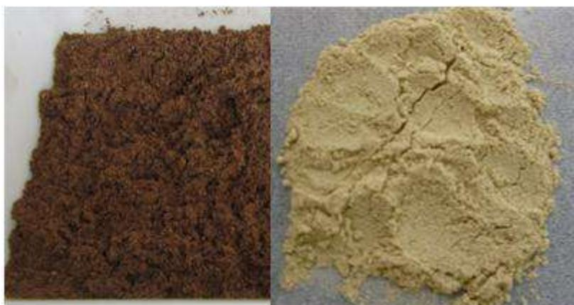
Figura 10. Tipos de bagaço de cana-de-açúcar utilizados nos ensaios de hidrólise enzimática. Pré-tratamentos utilizados: moinho de bolas (direita) e tratamento hidrotérmico (esquerda).
