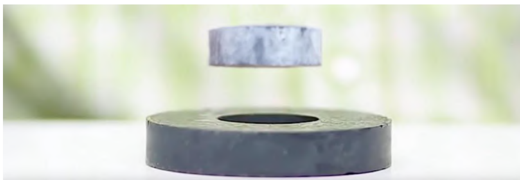
Figura 13 - Efeito Meissner em um ímã em formato de anel Fonte: Shutterstock
