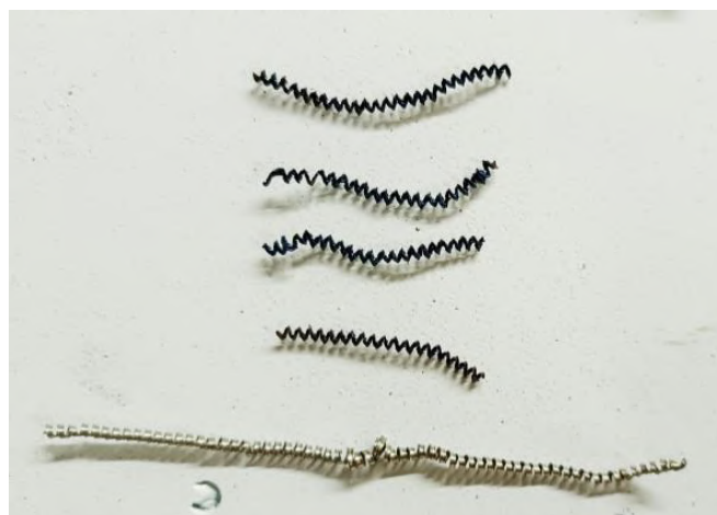
Figura 24 - Cavaco antes e depois da quebra da ferramenta (PRÓPRIO AUTOR, 2023).
