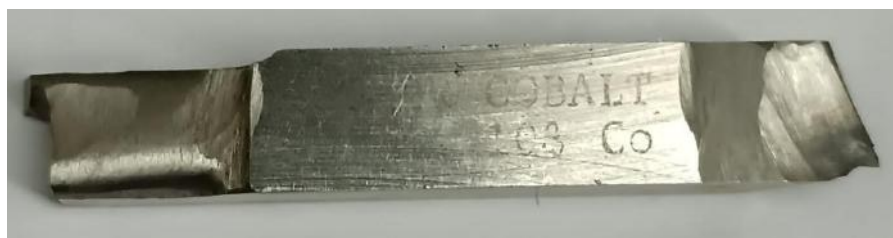
Figura 20 - Bit de aço rápido (grupo M) 10% de cobalto fabricante Ades Ferramentas (PRÓPRIO AUTOR, 2023).
