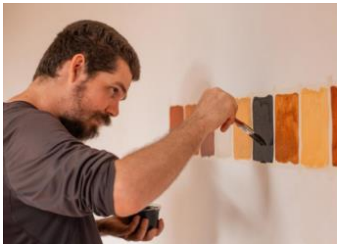
Figura 41 Paleta de cores para avaliação da cor e cobrimento (Fonte: Manual Cores da Terra, 2021)
