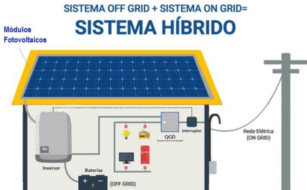
Figura 8 Sistema fotovoltaico híbrido (Fonte: Oca Solar Energia, 2021)
