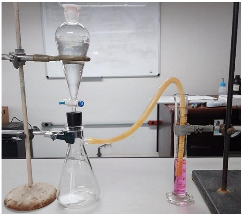
Figura 3 – Aparato Experimental do Kit Processo de Absorção de CO 2
