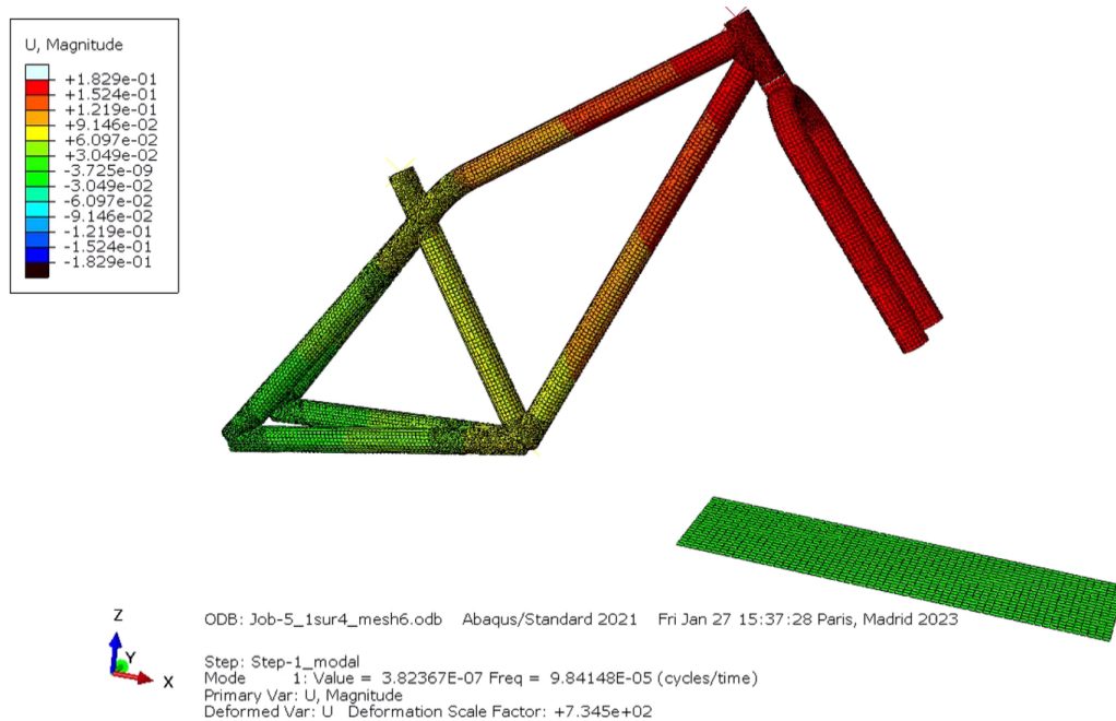
Figura 6.8: Início do primeiro modo de vibração. Fonte: ABAQUS®/Standard
