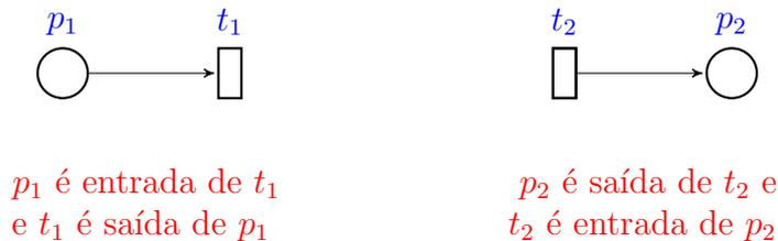
Figura 2.3: Entradas e saídas dos nós de uma rede de Petri
