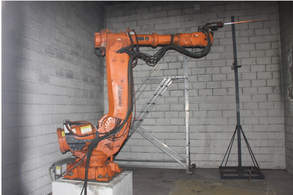
(a) Manipulador Robótico Realizando Hard Coating
