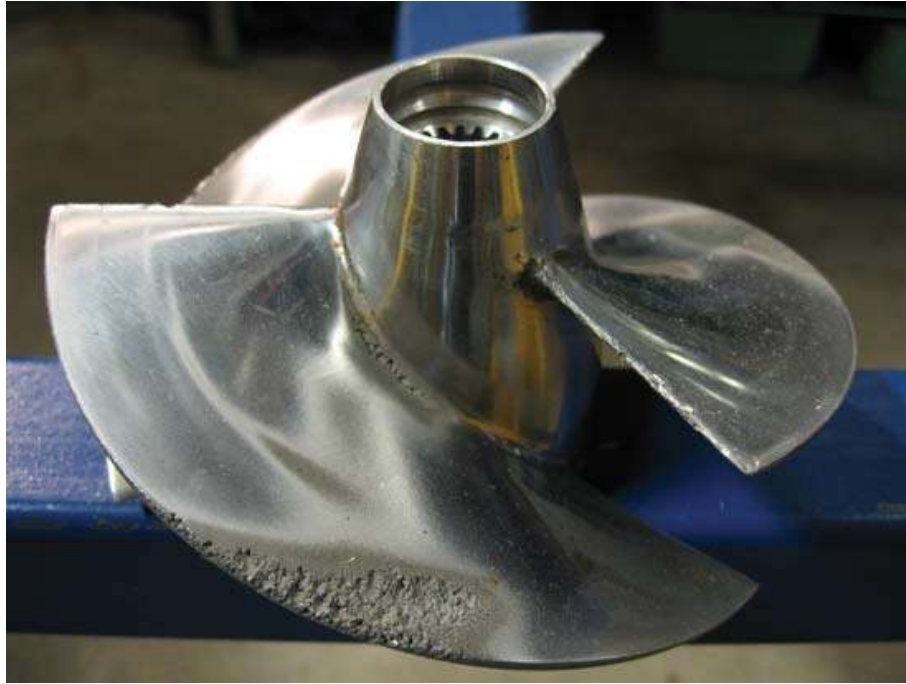
Figura 1.2: Efeito da Cavitação em uma Turbina ( https://www.britannica.com/science/cavitation ).
