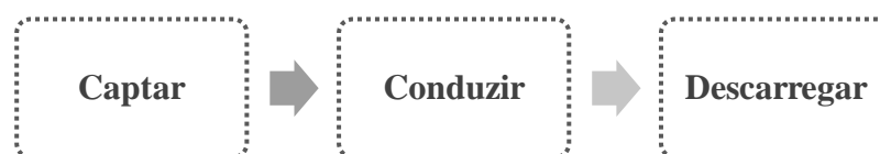
Figura 2.2: Conceito Tradicional de Drenagem
