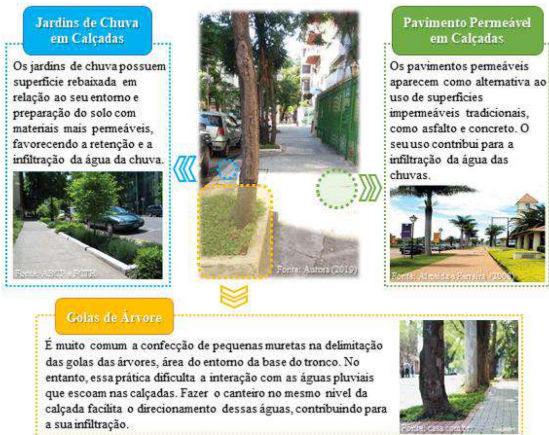
Figura 2.20: Possibilidades de Introdução de Medidas de Drenagem Urbana Sustentável no meio urbano – Escala da Calçada
