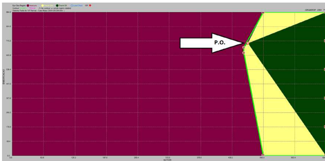
Figura 4.2: Nomograma: eixos G_1 \times G_2 para caso base
