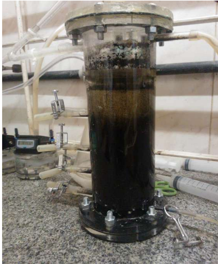
Figura 3.1: Reator UASB de bancada usado neste projeto, com espuma formada na superfície.
