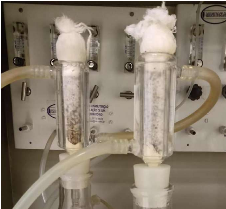
Figura 4: Sistema de biorreator de leito fixo para produção de lipase por FES utilizando o microrganismo Rhizopus oryzae e torta de algodão como substrato. Sistema composto por coluna com jaqueta d'água em torno do reator e aeração forçada para o controle de transferência de massa e calor ao longo do sistema.
