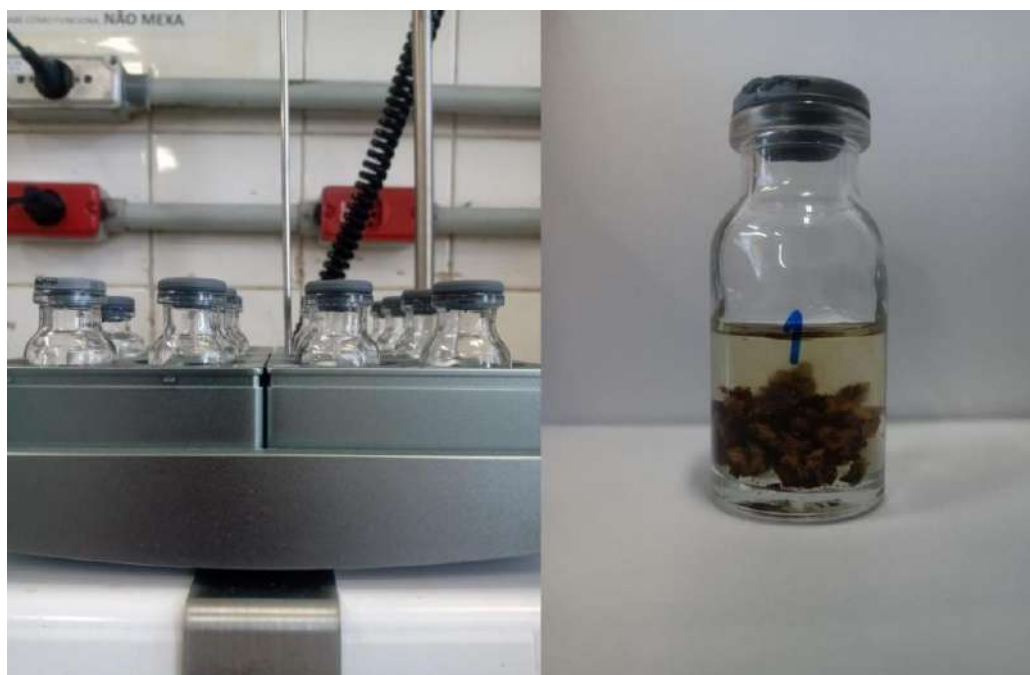
Figura 9: Sistema utilizado para a reação de esterificação de ácido oleico e etanol em leito agitado, utilizando o preparado enzimático produzido pela fermentação em estado sólido de Rhizopus oryzae como biocatalisador, a temperatura de 40°C.
