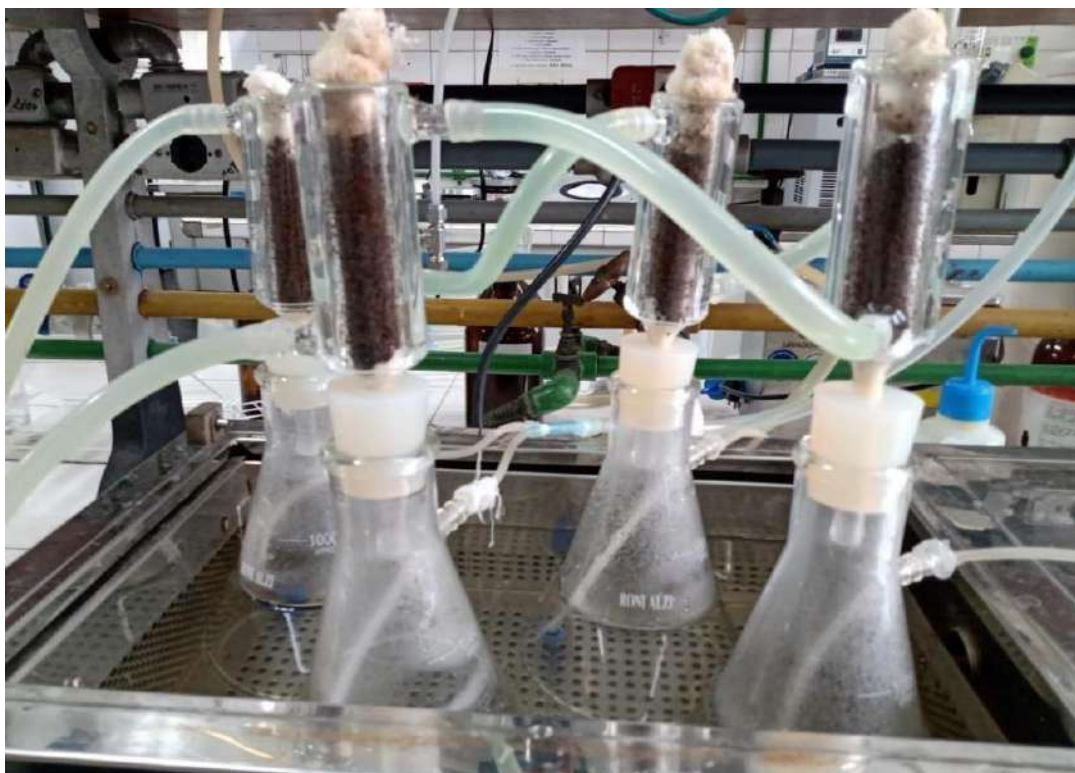
Figura 7: Biorreator de Leito Fixo composto por colunas de vidro acopladas a um kitassato de 1000 mL com controle de temperatura através da circulação de água através da jaqueta d'água presente nas colunas.
