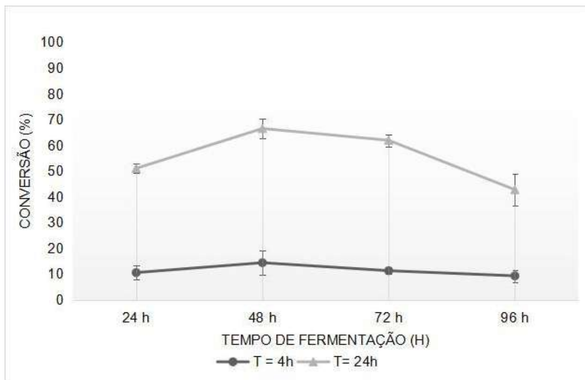
Figura 12: Cinética da produção de lipase produzida por Rhizopus oryzae utilizando torta e fibra de dendê (80:20) como substrato. Os sólidos fermentados foram caracterizados quanto a sua capacidade de catalisar a reação de esterificação entre ácido oleico e etanol, os tempos de reação de 4 e 24 horas.
