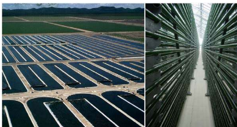
Figura 35: Exemplos de cultivos de microalgas. À esquerda tanques abertos e à direita tanques fechados. Fonte: Styring, 2011
