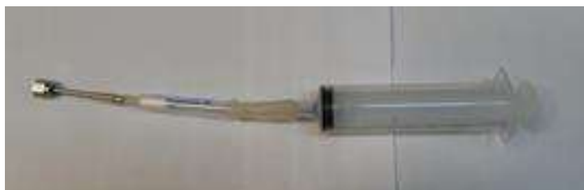
Figura 5.8. Seringa de coleta para medição do alcatrão.
