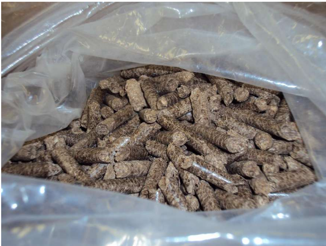
Figura 5.4. Fotografia dos pellets de bagaço de cana-de-açúcar utilizados nos experimentos de gaseificação.
