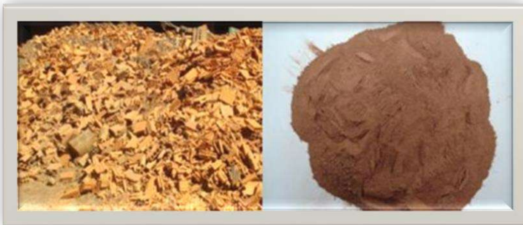
Figura II.1 – Sobras de Tijolos: (a) coletada no canteiro de obra, (b) após a cominuição
