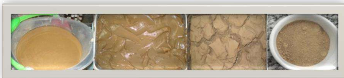
Figura II.2 – O lodo em diversas etapas: (a) após a coleta na etapa de decantação,(b) após a separação da fase líquida,(c) depois de seco ao ar, (d) depois de cominuído.
