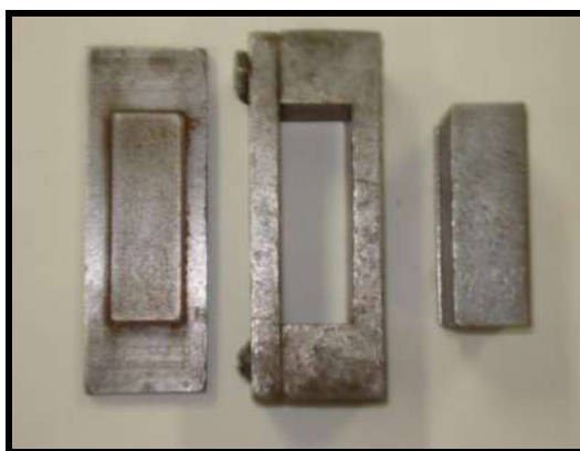
Figura II. 5 – Matriz retangular de aço inox utilizada na compactação dos corpos de prova.
